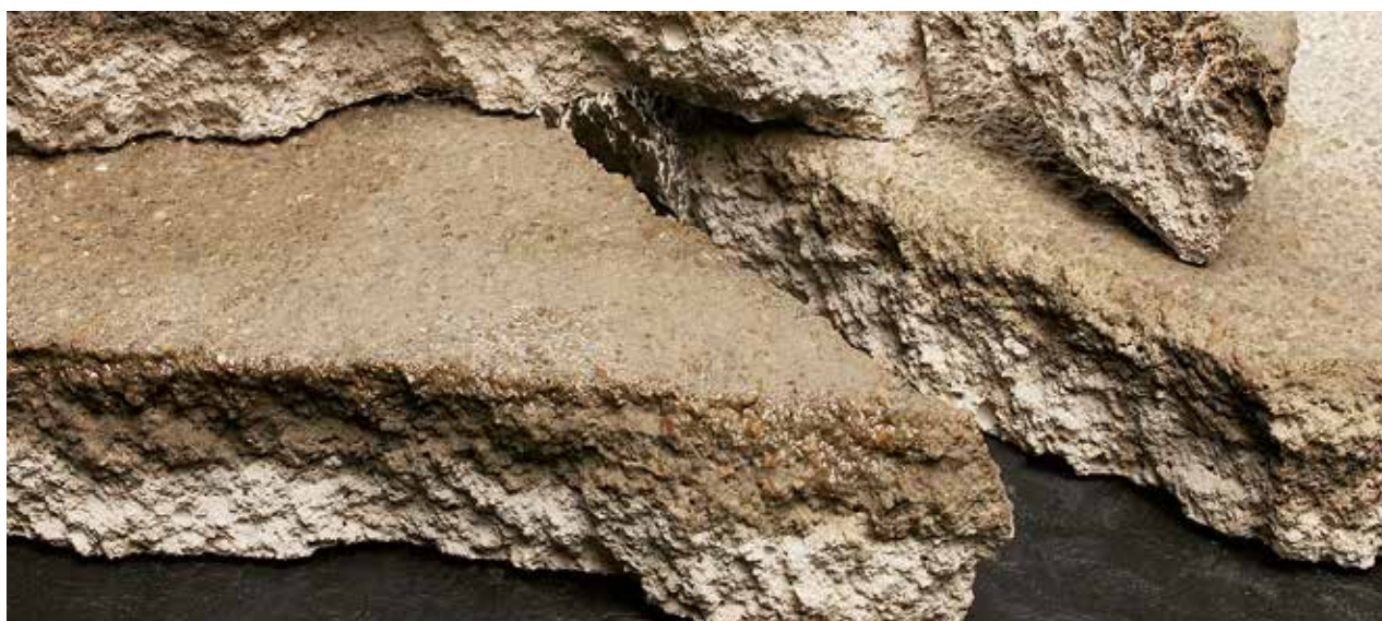
Detalle de fragmentos de un enfoscado al que se ha aplicado consolidante con un alto poder de penetración. ▲
