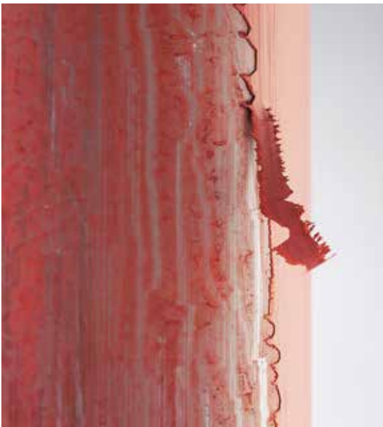
Imagen izquierda: bajante de PVC cubierto con pintura plástica, tras haber sido raspado con una espátula.
