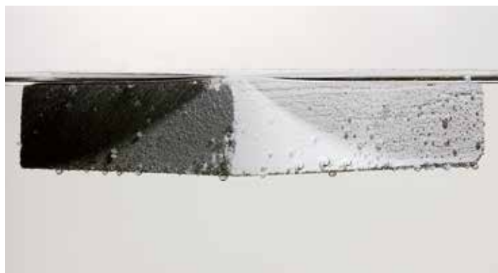
▲ Pieza de M. Antihumedad Rehabilitador BME 4508G de 3 cm de grosor, introducida en agua, que debido a su bajo peso, flota en el agua.
