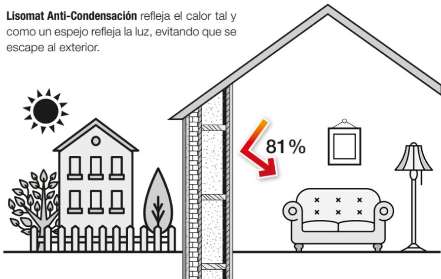
Ensayos de un laboratorio independiente\* demuestran que **Lisomat Anti-Condensación** devuelve al ambiente más del 81% del calor que se irradia a la pared\*\*.
